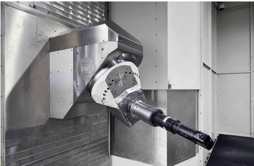
1 HVC-Kopf zur 5-Seiten-Simultan-Bearbeitung: Bis zu 75 kg schwere Werkzeuge (inklusive einer automatischen Werkzeugverlängerung) lassen sich für tieferliegende Bohrungen adaptieren und um \pm 225 Grad schwenken © Arburg
